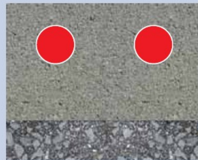
Heizdrähte in Zementestrich
